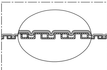
**Abriebfester, ölbeständiger und mit Polyurethan ummantelter Metall-Schutzschlauch; halogenfrei und hochflexibel; sehr robust und flüssigkeitsdicht; eingehaktes Metallprofil**
