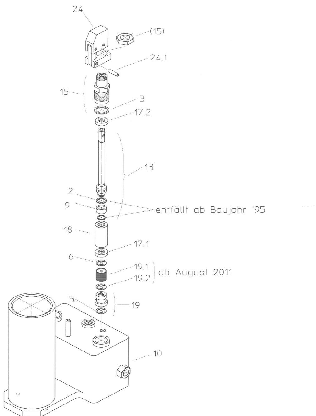
(...) Das mit Klammer gekennzeichnete Teil ist Bestandteil des in Klammer genannten Ersatzteils.
