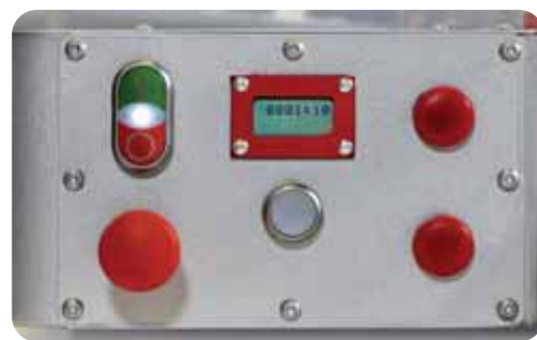
Bedientableau am ROBOT mit Betriebsstundenanzeige und NOT AUS Operating panel with service meter and Emergency Stop
