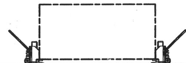
Podnoszenie na wsporniku przy pomocy dwóch dźwigników (dwóch operatorów)
